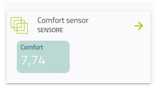
**N.B.** Per un corretto funzionamento del sensore virtuale di comfort è necessaria l'associazione del dispositivo Multi sensore 6in1: il sensore di movimento, temperatura, umidità, vibrazione, shock e UV.
